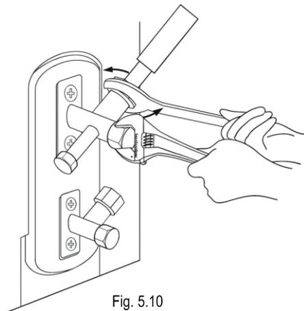
5. Mientras sujete firmemente el cuerpo de la válvula, use un torquímetro para apretar la tuerca acampanada de acuerdo con los valores correctos de torque.
