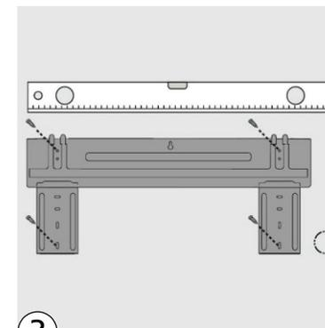
**3** Instale la placa de montaje.
