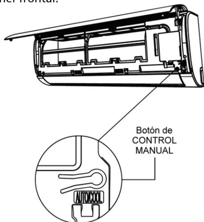
**PRECAUCIÓN:** El botón de CONTROL MANUAL está diseñado solamente con propósitos de prueba y de operación de emergencia. Por favor no use esta función a menos que haya perdido el control remoto y sea absolutamente necesario.
