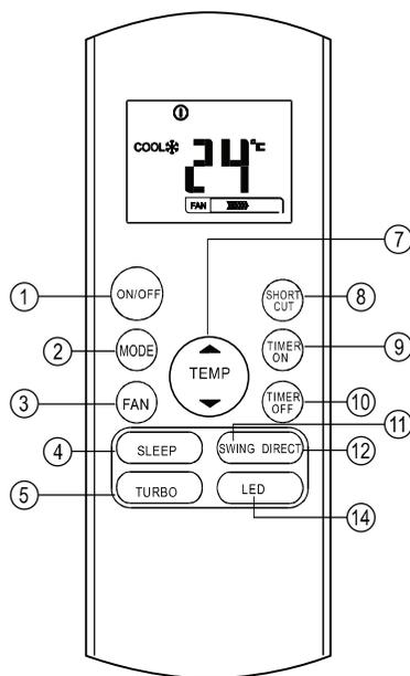
El aire acondicionado cancela automáticamente la función MI TEMPERATURA (MY TEMP) si no recibe la señal del control remoto en un intervalo de tiempo de 7 minutos.
