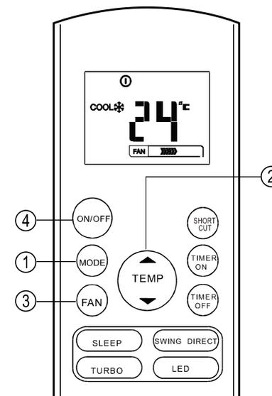
**Nota:** En el modo VENTILADOR (FAN) la pantalla del control remoto no muestra ninguna temperatura programada, y usted no podrá controlar la temperatura de la habitación. En este caso, solamente pueden seguirse los pasos 1, 3 y 4.
